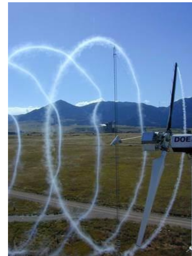
Figure 146 : Effet de sillage derrière une éolienne bi-pale visualisé à l'aide d'un traceur fumée (source : http://www.energieplus-lesite.be )
